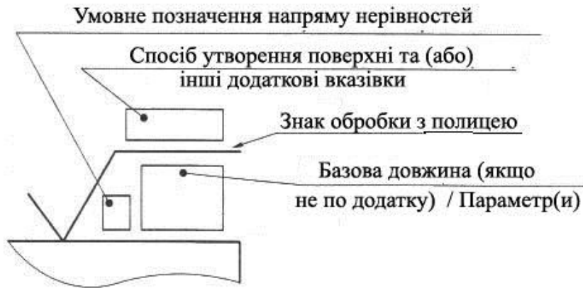
Рисунок 28 – Структура позначення шорсткості поверхні
